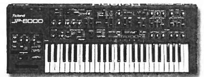
клавиша, колеса Pitch Bend и программируемого контроллера, два MIDI-выхода, гнездо для педалей Sustain и Volume, октавная перестройка, переключение каналов, режим передачи команд, питание — 9 В постоянного тока (источник в комплекте).
